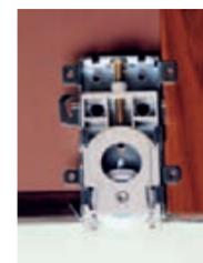
Механизмы смонтированы в накладных стальных корпусах, которые одновременно выполняют функцию наружных угловых соединителей для рамы.
