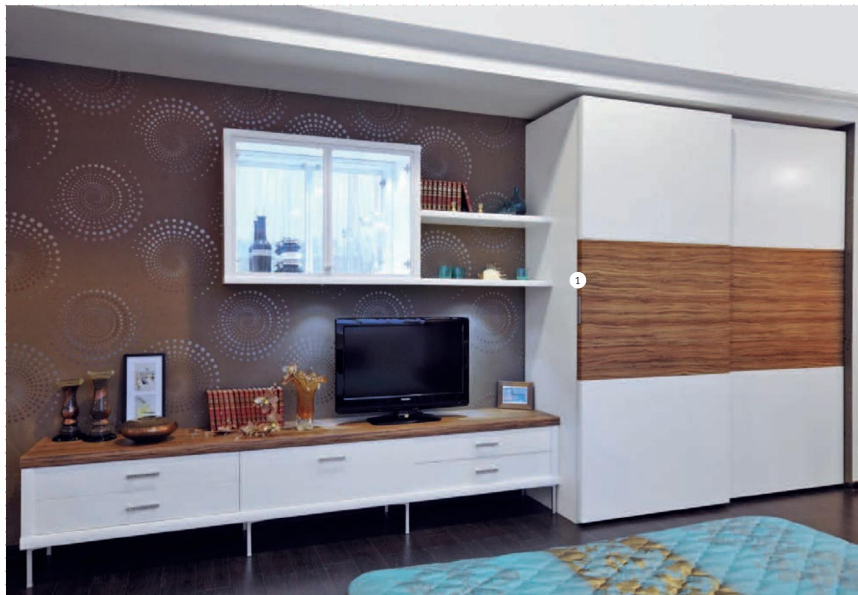
Корпус тумбы, на которой размещён телевизор, выполнен из панелей «Тамбурато» толщиной 36 мм, — как и вся мебель в этой спальне. Панели «Тамбурато» заметно прочнее и толще ламинированных плит, обычно применяемых при изготовлении мебели, но значительно легче, за счёт использования внутреннего сотового наполнителя.
