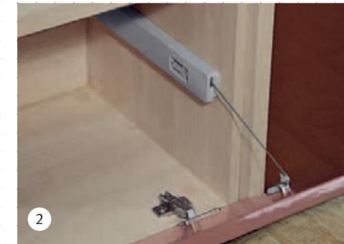
Лифт «Винч» предназначен для откидных фасадов, открываемых вниз. В этом механизме использована тросовая система, которая позволяет дверце плавно закрываться, не требуя доводчика.
